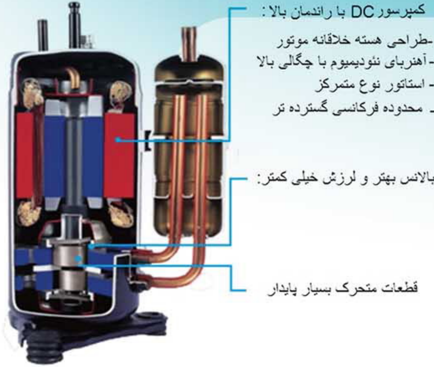
کمپرسور دو سیلندر روتار اینورتر DC
